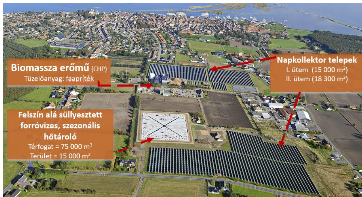
15. ábra: A Dániában található ~2200 lelkes Marstal “hibrid” távfűtő rendszere madártávlatból
