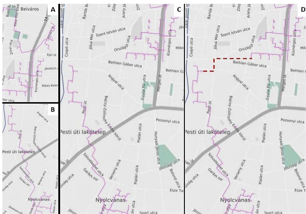
4. ábra A gyöngyösi távhőrendszer vezetékhálózata. A lila színű folytonos vonal = meglévő távhővezeték, piros színű szaggatott vonal = a távhőrendszereket összekapcsoló elméleti nyomvonal. Az (A) jelű képvágás a Mérges úti fűtőműhöz tartozó rendszert, a (B) jelű az Olimpia úti fűtőmű által ellátott rendszert, a (C) jelű a két távhőkörzet egymáshoz viszonyított helyzetét, a (D) jelű pedig a rendszerek közötti provizórikus összekötési lehetőséget ábrázolja. Forrás: E-közmű
